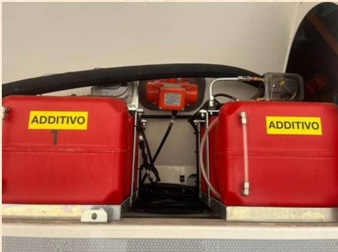
La struttura interna dell'impianto separa le materie prime in compartimenti distinti e mescola solo ciò che è necessario, seguendo una ricetta preimpostata. Questo processo è gestito da un computer di bordo intuitivo, che controlla la pesatura del cemento, degli inerti, degli ossidi coloranti, il dosaggio degli additivi e dell'acqua.
