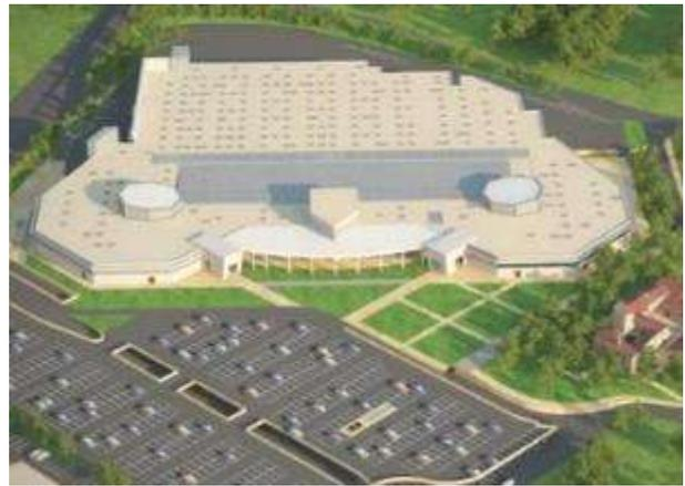
Isolamento termo-acustico di **24.000 mq** di copertura **in completa sostituzione dell'isolante leggero tradizionale** con spessore medio 15 cm e fissaggio diretto dell'impermeabilizzazione
