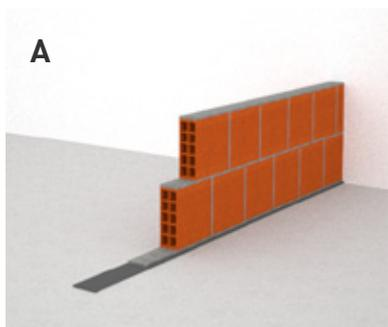
Prima di iniziare la posa di tutte le tramezzature, è necessario procedere alla posa di Isolmant Fascia Tagliamuro. Questo accessorio in polietilene espanso reticolato ad alta densità è specifico per desolidarizzare le tramezzature dal solaio contribuendo in tal modo a ridurre la trasmissione strutturale del rumore dalle pareti al solaio stesso. Tale fascia è disponibile in diversi spessori e densità in funzione del peso delle tramezzature (dis. A).
